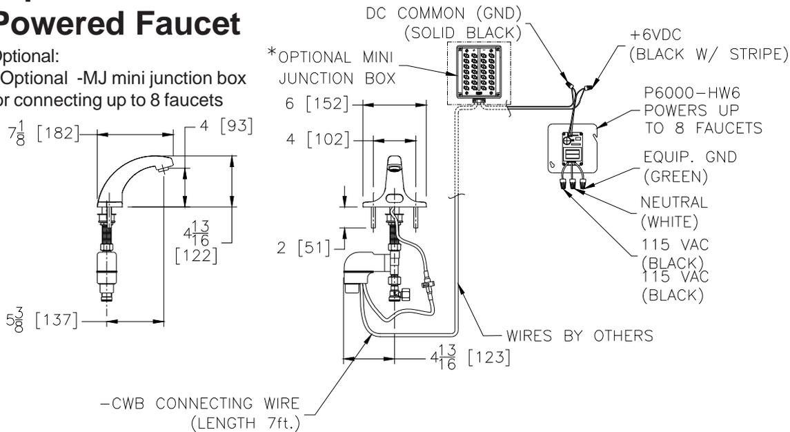
**NOTE: MUST USE EITHER ZURN P6000-HW6 HARDWIRE POWER CONVERTER OR ZURN P6000-PC6 PLUG-IN POWER CONVERTER TO ENSURE PROPER OPERATION. USING A POWER CONVERTER OTHER THAN ZURN MAY RESULT IN OPERATION MALFUNCTION OR UNIT FAILURE.**
